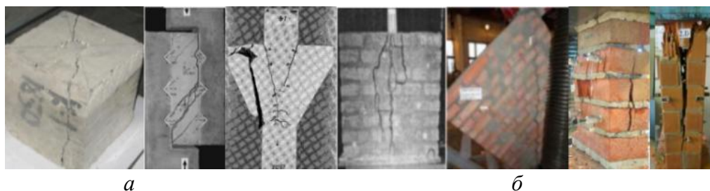
Рис. 1. Випадки розколювання в залізобетоні (а) та кам'яній кладці (б)
