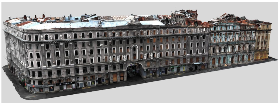
Рис. 3. Mesh модель руйнувань Палацу праці (м. Харків)
